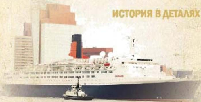
согласованной с обществом Ллойда. Максимальная скорость судна составила 34,6 узла, а максимальная скорость заднего хода 19 узлов, при оговоренной контрактом, 13 узлов.
