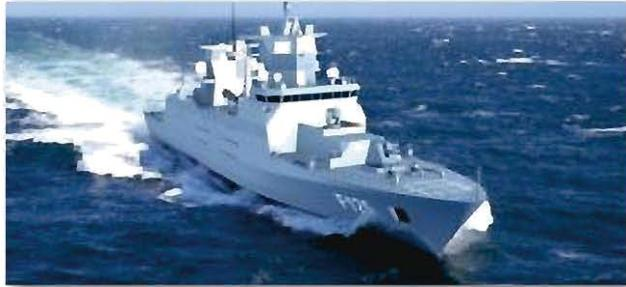
Основные характеристики: Водоизмещение 7100 тонн. Длина 149 метров, ширина 18,8 метра, осадка 5,0 метров. Скорость хода 26 узлов. Дальность плавания 4000 морских миль на 18 узлах. Экипаж 120 человек, а также 70 человек специального назначения.
