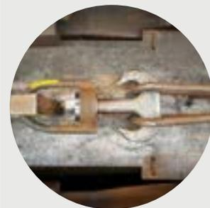
Голландская компания Huisman поставила первые в своем классе сертифицированные грузовые крюки для кранов, напечатанные на 3D-принтере. После испытаний в условиях удвоенной безопасной рабочей нагрузки эти крюки были сертифицированы для использования на судах в соответствии со стандартами ABS.
